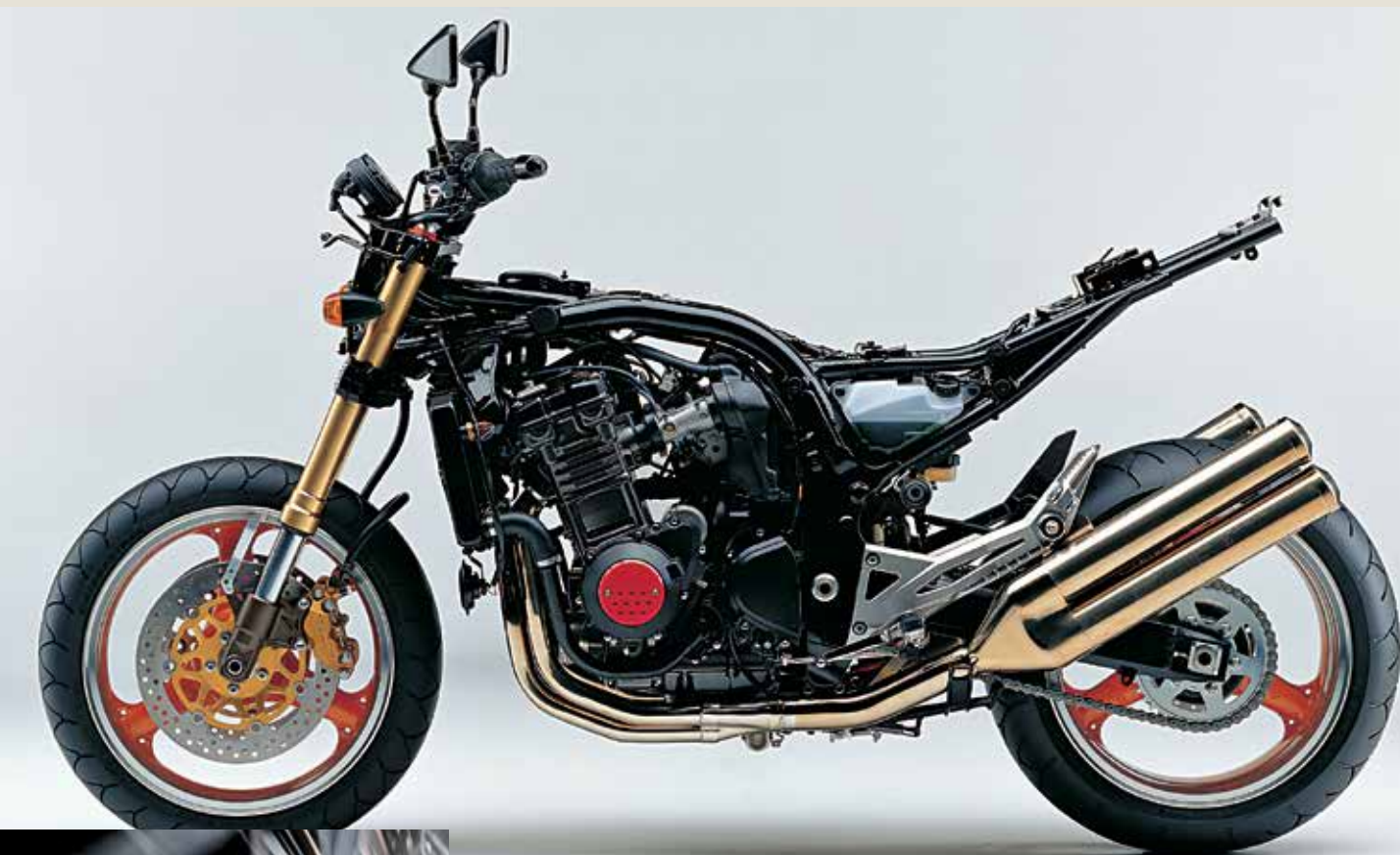
Cevni jeklen okvir je bil predhodnik aktualne gradbene filozofije pri zelenih. Tako vpet motor je bolj dostopen za mehanikarsko delo.
