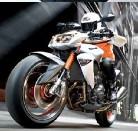
Cevni jeklen okvir je bil predhodnik aktualne gradbene filozofije pri zelenih. Tako vpet motor je bolj dostopen za mehanikarsko delo.
