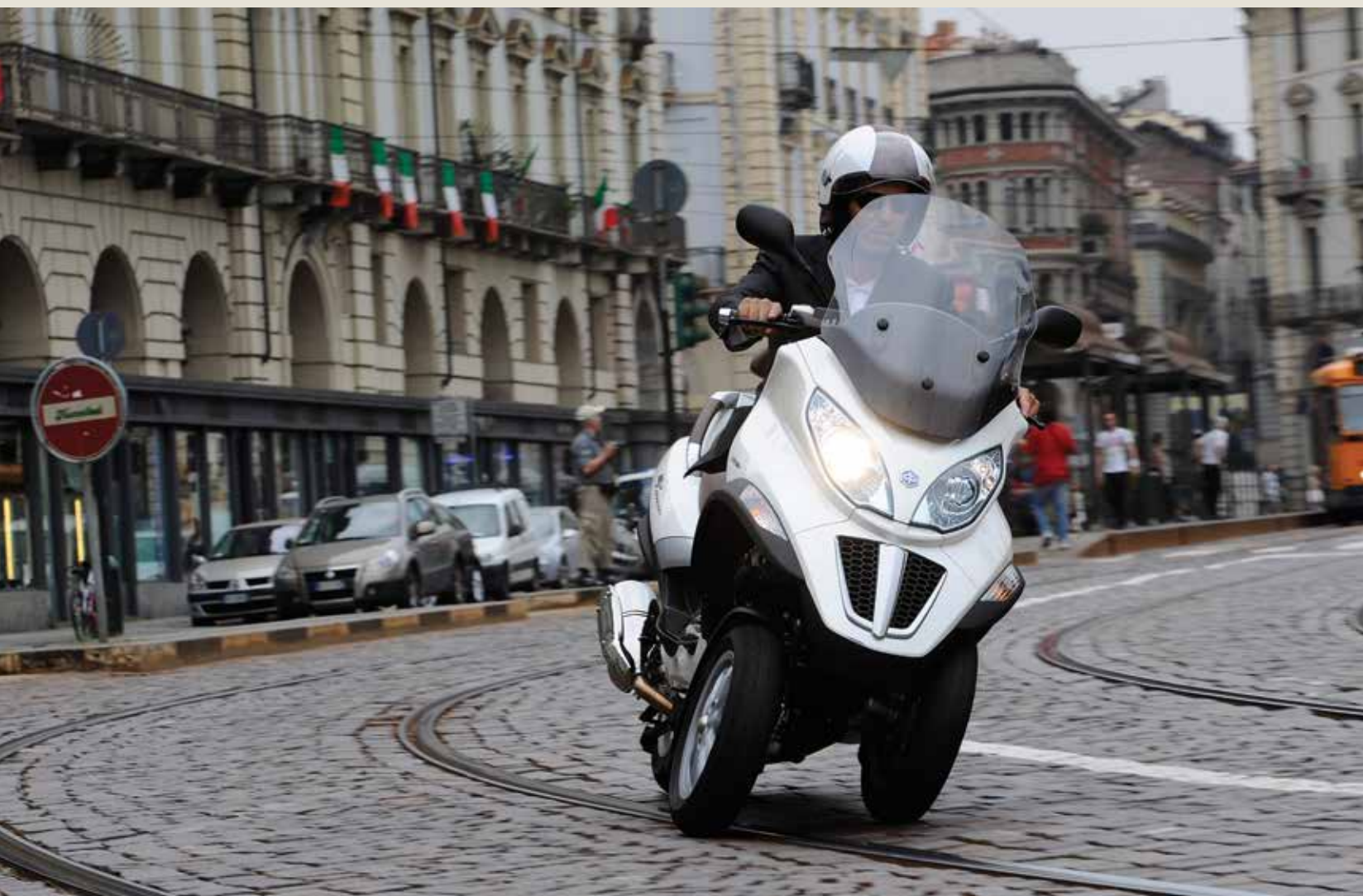
Dobro izveden tricikel je izredno stabilen in ga je kar težko prevrniti. Dve kolesi spredaj sta prednost na gladkem vozišču, na kockah, na tirih.
