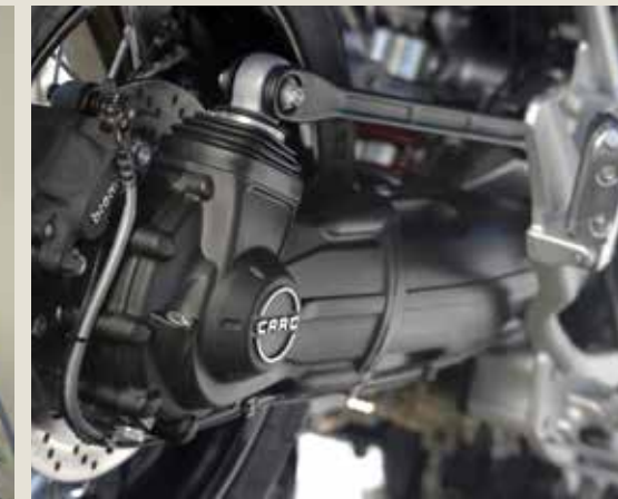
Kardanski prenos je solzil olje le v prvi generaciji. Ročno pomičen vetrobran je izboljšal udobje v vožnji.
