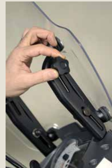
Kardanski prenos je solzil olje le v prvi generaciji. Ročno pomičen vetrobran je izboljšal udobje v vožnji.
