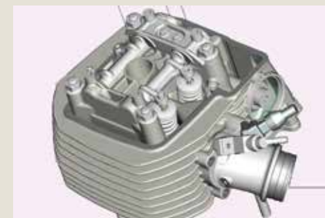
Dročniki so bili v prvi seriji problem, ker jih je požrlo. Uradnega vpoklica ni bilo.
